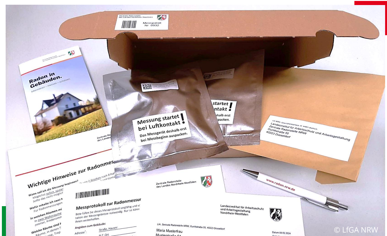
Abbildung 2: Messpaket für jeden teilnehmenden Privathaushalt, inklusive zwei luftdicht verpackter Radonmessgeräte, Anleitung zur Messung, Messprotokoll und Rückumschlag.
